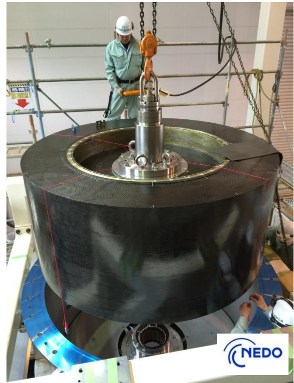
世界最大級の CFRP 製フライホイール
