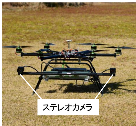
図 5 空撮測量システム
