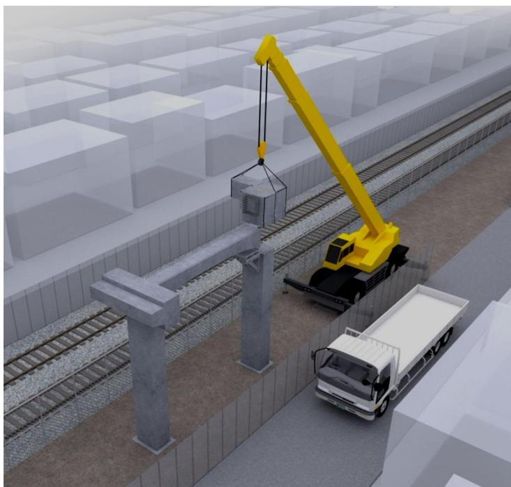
参考図 プレキャストラーメン高架橋の施工イメージ
