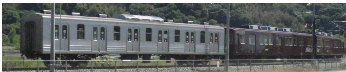
写真2 走行試験の様子（左1両が試験車両、右奥2両が牽引車両）
