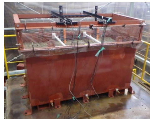
図2 小型模型による振動台実験
