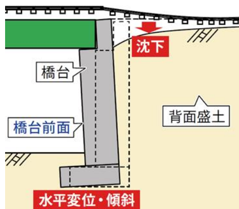
図2 過去の地震における橋台の被害例
