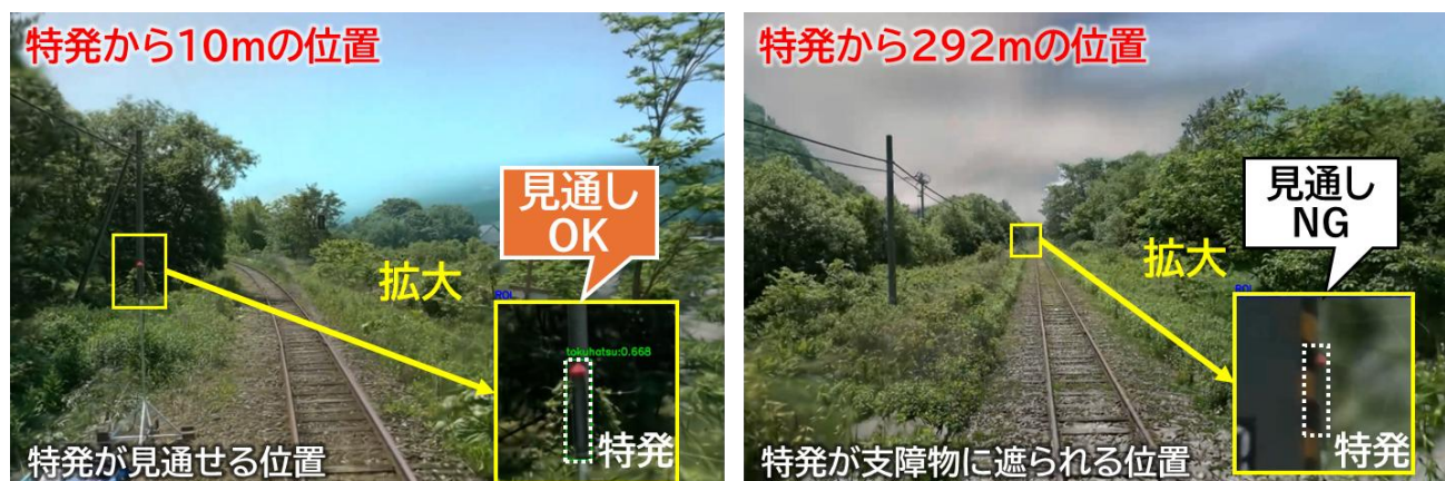
図 4 特発の見通し検査システムによる検証試験結果例(同じ特発での見通し例)
