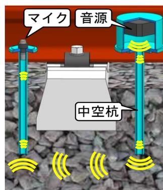
図2 バラスト道床内における音の伝搬のイメージ
