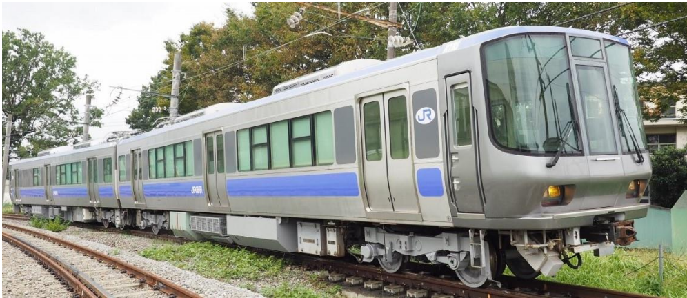
図1 燃料電池ハイブリッド試験電車
