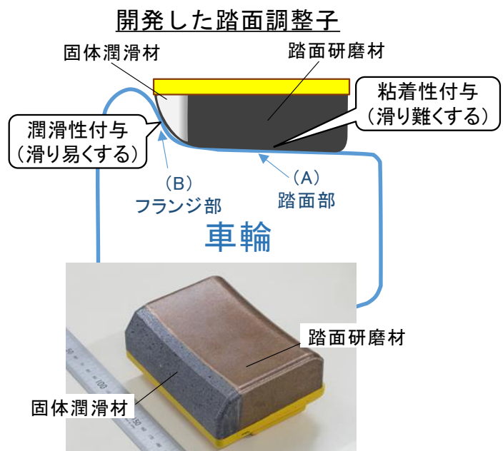
図1 開発した踏面調整子 （粘着性能と潤滑性能を付与）
