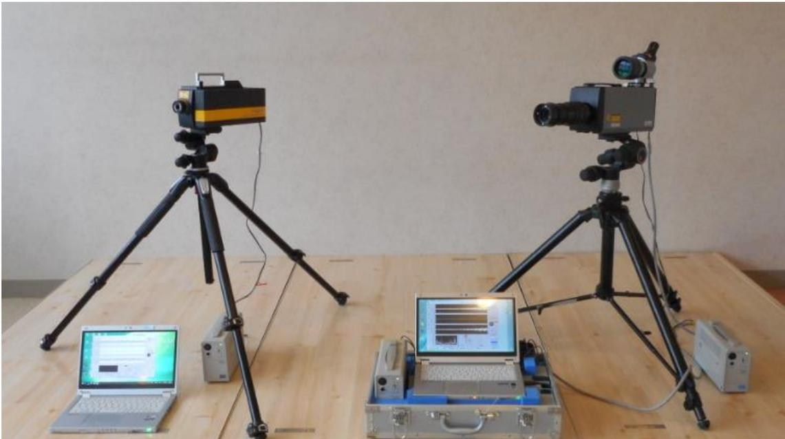
写真 非接触振動測定システム（左：UドップラーⅡ 右：UドップラーⅠ）
