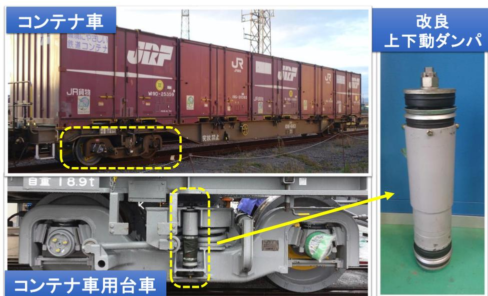
図1 コンテナ車用台車の改良上下動ダンパ
