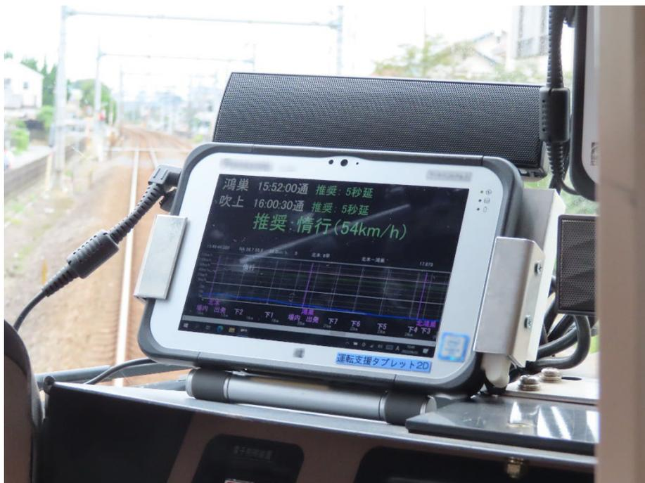
図1 運転支援システムの運転台への設置事例
