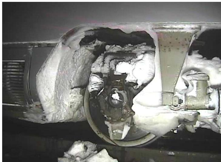
図1 実車両への着雪状況例
