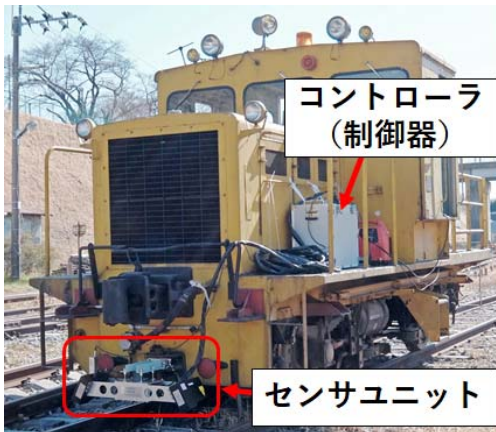
図1 TRACK 2 er 搭載の様子
