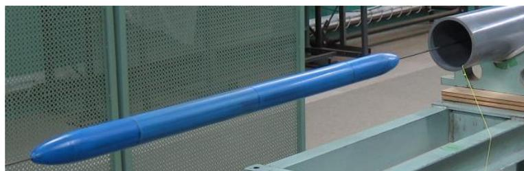
図3 軸対称断面形状の列車模型（従来装置）
