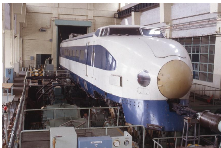
図 2 山陽新幹線用試験電車の試験の様子
