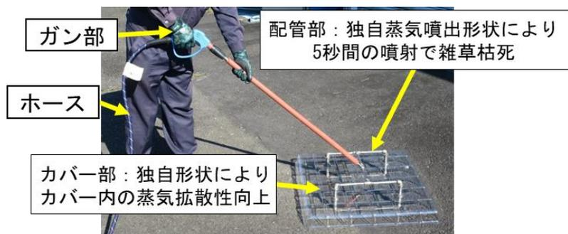
図2 新たに開発した手持ちノズルの構成
