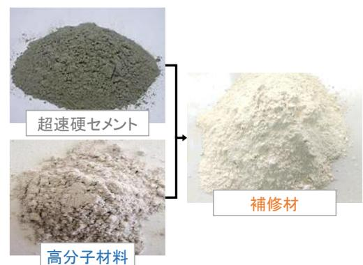
図2 開発した補修材
