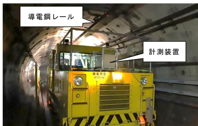
図4 東京都交通局大江戸線における剛体電車線（導電鋼レール）の計測の様子
