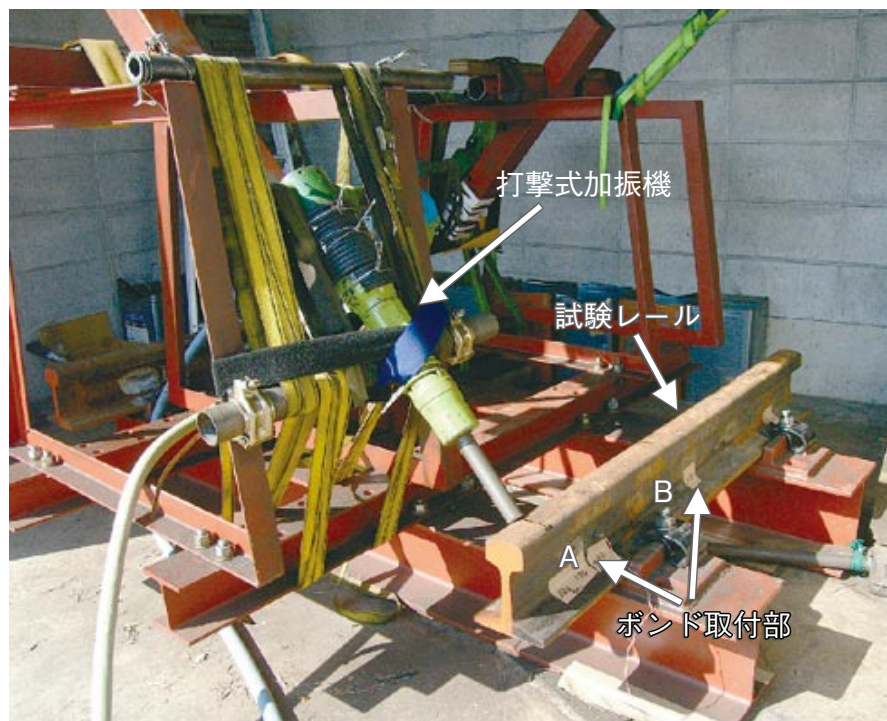
図 試作振動試験装置
