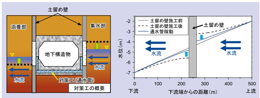
図 3 次元浸透流解析結果例
