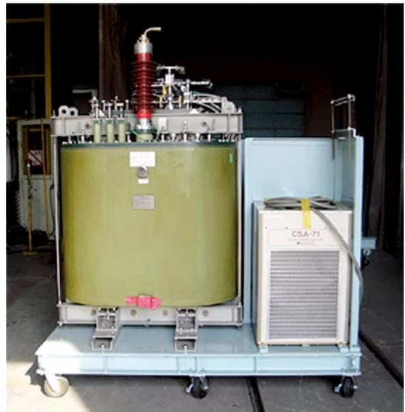
図 低交流損失超電導線による巻線および軽量、大容量な冷却システムを組み込んだ超電導主変圧器
