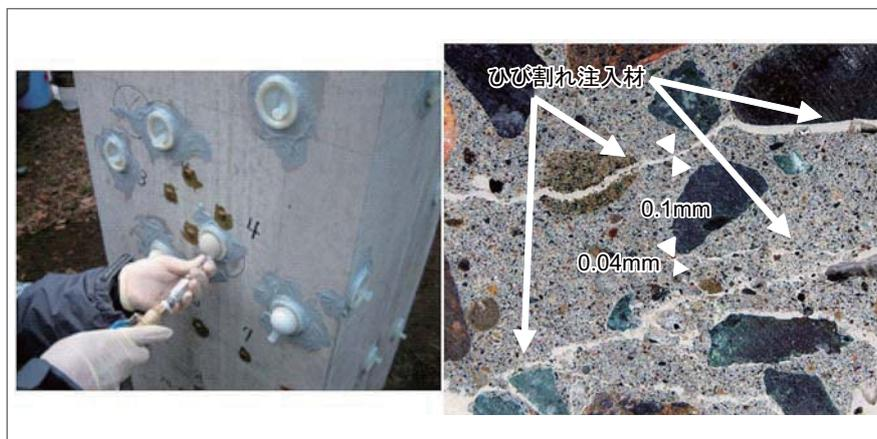
図 大型供試体への注入状況並びに注入材のひび割れ注入状況
