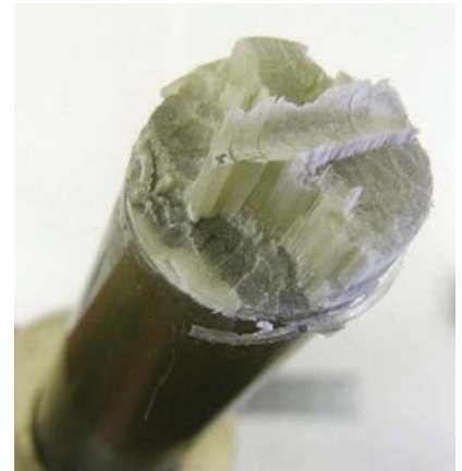
図 蒸留水環境で生じたFRPの脆性破壊の破面
