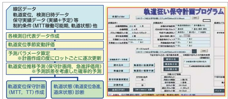
図 高頻度検測データ対応版軌道変位保守計画モデル, システム
