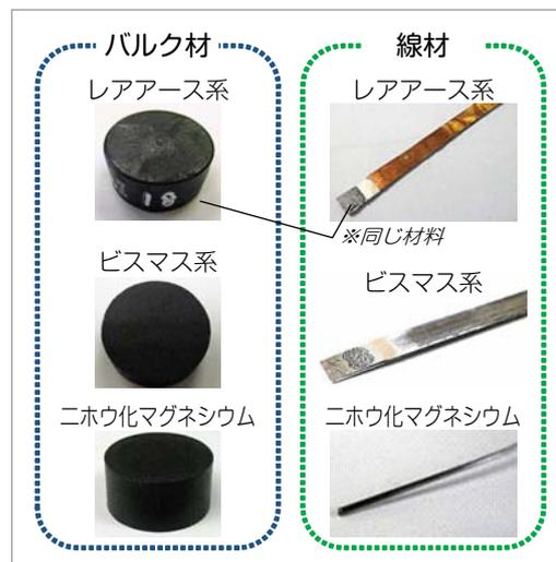
図 超電導材料の種類
