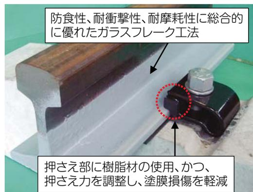
図 提案したレール防食工法および締結装置の概要
