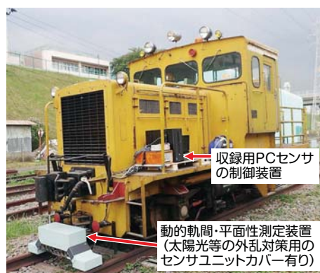
図 動的軌間・平面性測定装置
