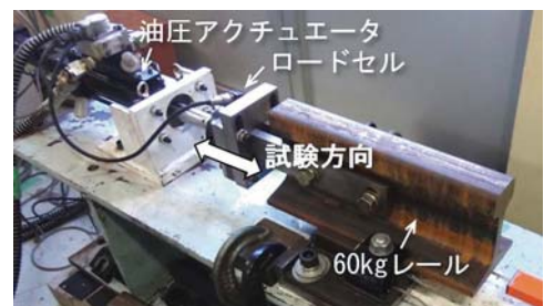
図2 抜け出し防止効果の検証試験
