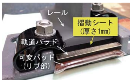
図1 摺動シートの設置状況
