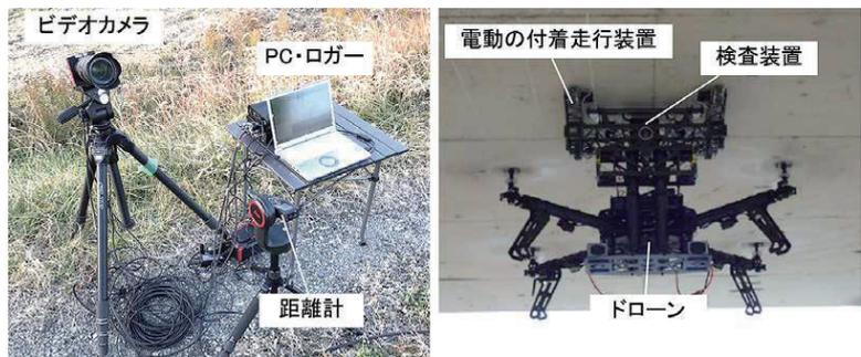
図 ビデオによる多点同期振動測定システム（左図）と構造物検査ドローン（右図）
