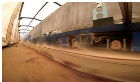
図3 模擬雪による車両模型走行実験
