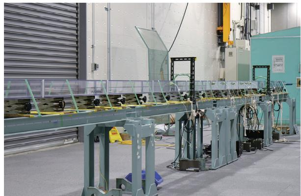
図6 スノーシェルターに関する模型実験
