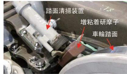
図2 踏面清掃装置および増粘着研磨子
