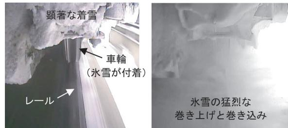
図 18 レール/車輪間の映像例（220km/h 時）
