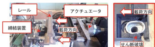
図9 横圧強度試験の破壊状況 (FRTP)
