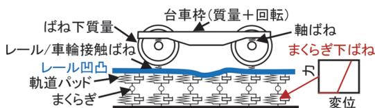
図5 車両走行シミュレーションモデル
