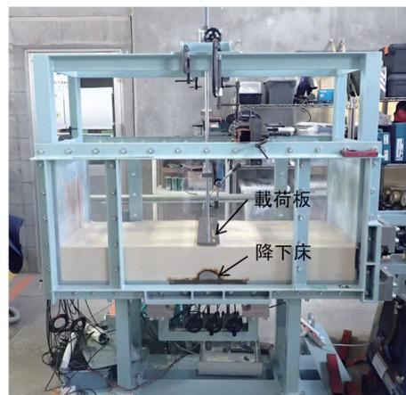
図5 降下床実験装置
