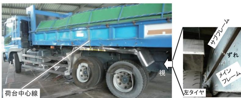
図6 ダンプトラックの変形状況
