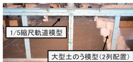
図11 応急復旧した盛土模型の外観 (case 7)
