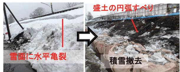
図1 積雪斜面（盛土）における崩壊事例<sup>1)</sup>
