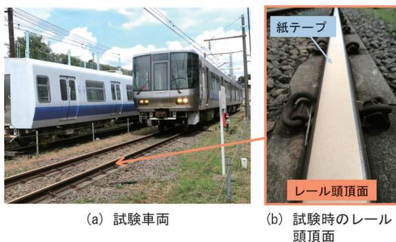
図1 実車制動試験の様子
