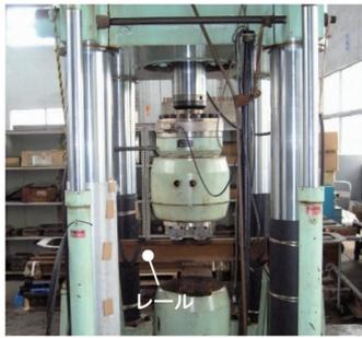
図9 曲げ疲労試験状況
