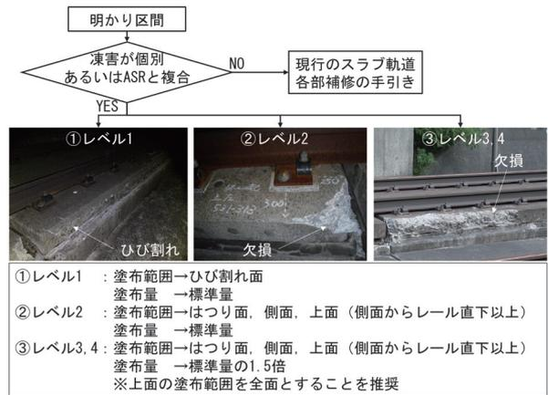
図17 シラン・シロキサン系含浸材による軌道スラブの補修範囲と塗布量
