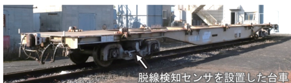
図11 脱線検知試験に使用した車両
