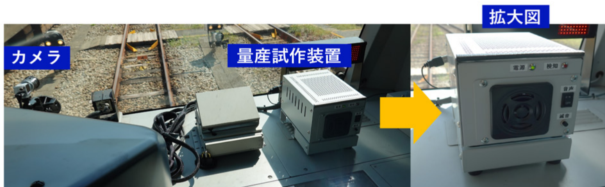
図 11 モニタラン試験時の装置設置状況知例
