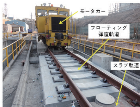
図9 モーターカー走行試験の様子
