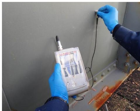
図1 電磁式膜厚計での膜厚計測例
