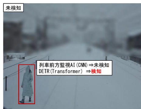
図 11 AI 構造の検査手法による推定例
