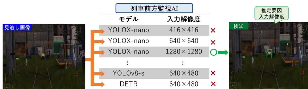
図 4 AI 構造の検査による判断ミス要因推定
