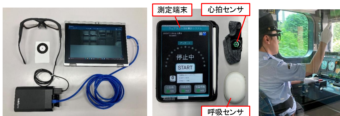
図 7 測定機材（左：メガネ型センサ 中央：生理計測システム CHET）と測定の様子（右）
