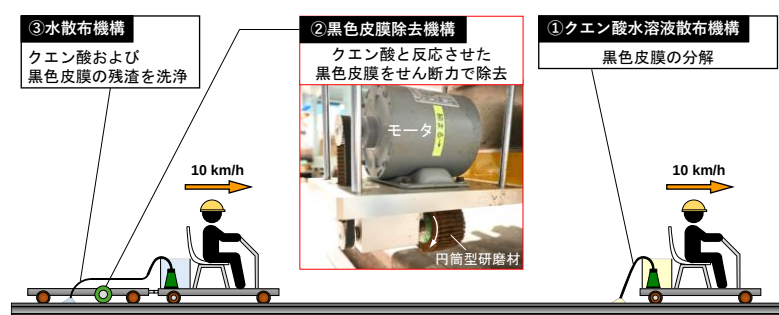
図 10 黒色皮膜除去装置の概要
