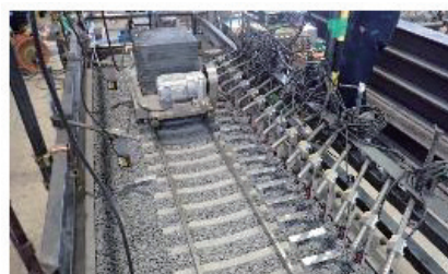
図5 小型模型の移動載荷試験状況
