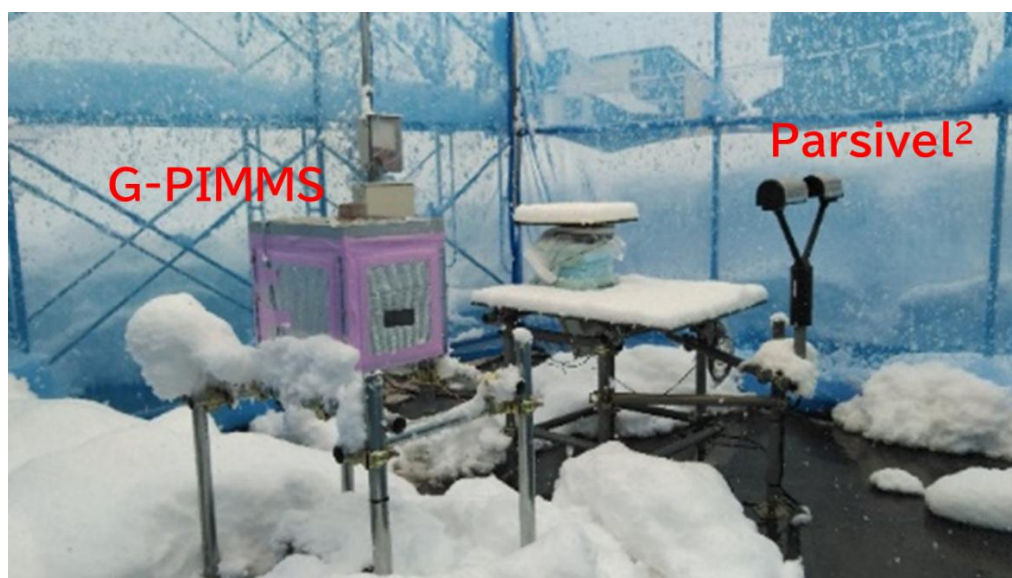
図4 防雪ネット内に設置したG-PIMMSとParsivel 2 . Takami et al. (2022) 11) より引用. ライセンス: Creative Commons Attribution 4.0 International.
