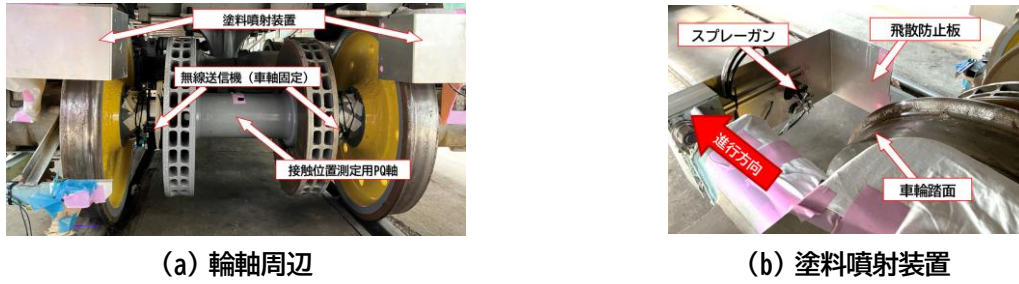
図 11 所内走行試験時の仮設状況
