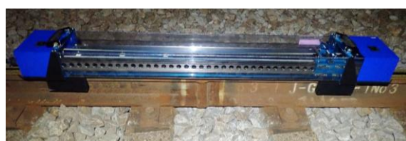
図 5 レール頭頂面凹凸測定器の概要
