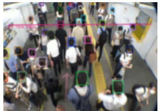
図2 AIを活用した断面交通量の計測
