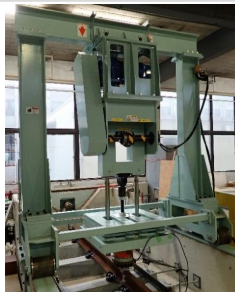
レール開口部の車両走行シミュレーションモデル
