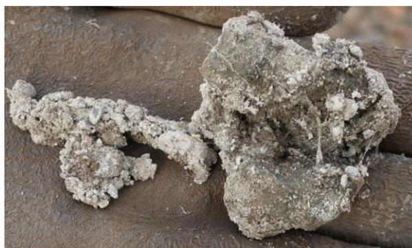
超速硬セメントにより安定処理
